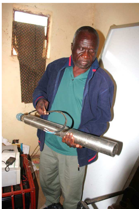
Flument Mkinga zeigt die Pumpe, die dann auch noch ersetzt werden musste
